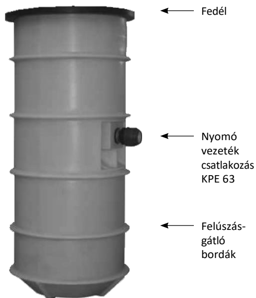
3. ábra: KN akna oldalnézet
