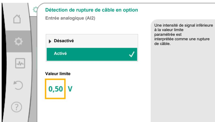
Fig. 57: Valeur limite de la rupture de câble
