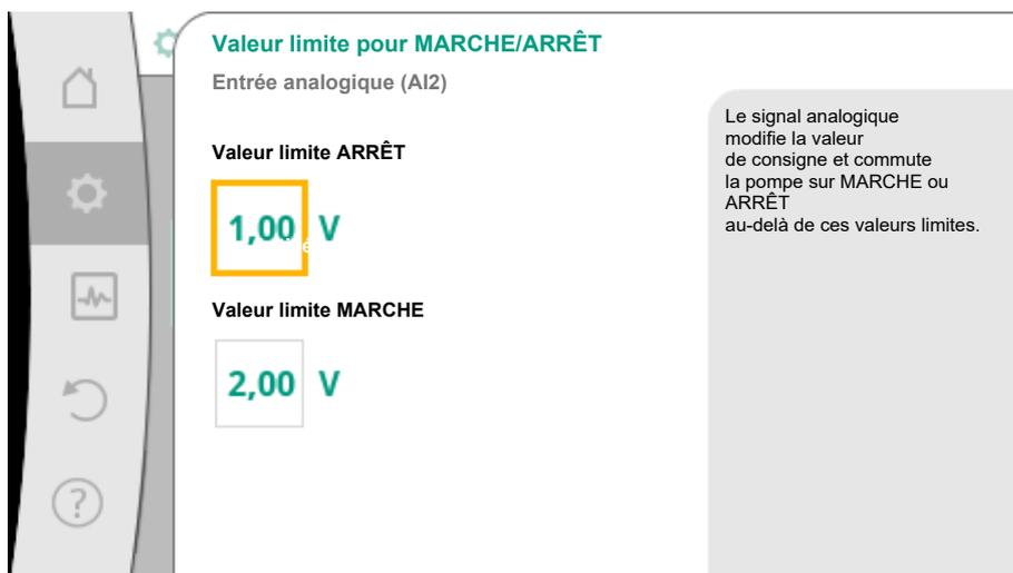
Fig. 59: Valeurs limites de la commande MARCHE/ARRÊT via signaux analogiques
