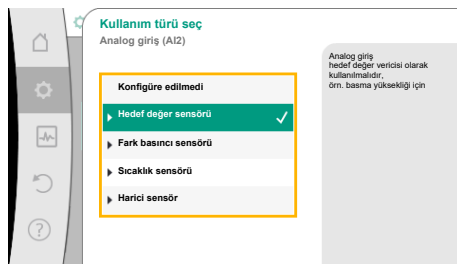
Fig. 69: Hedef değer sensörü ayar iletişim kutusu
