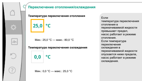
Fig. 52: Переключение отопления/охлаждения_Температуры переключения
