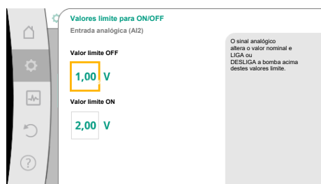
Fig. 81: Valores limite para o comando LIGAR/DESLIGAR através de sinais analógicos
