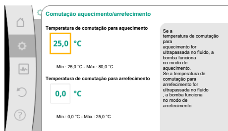
Fig. 52: Comutação aquecimento/arrefecimento_Temperaturas de comutação
