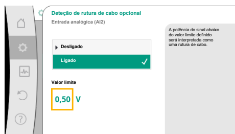
Fig. 79: Valor limite para rutura de cabo
