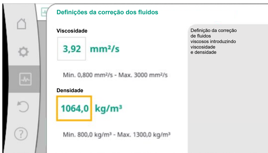
Fig. 98: Regulação da viscosidade e densidade
