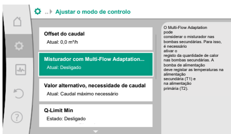
Fig. 60: Ajustar o modo de controlo: Misturador com Multi-Flow Adaptation
