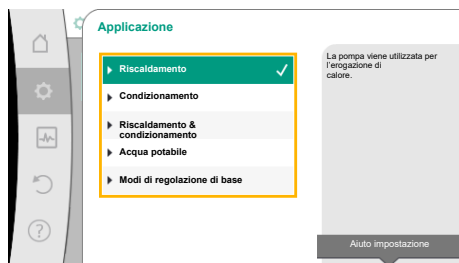
Fig. 41: Esempio applicazione "Riscaldamento"
