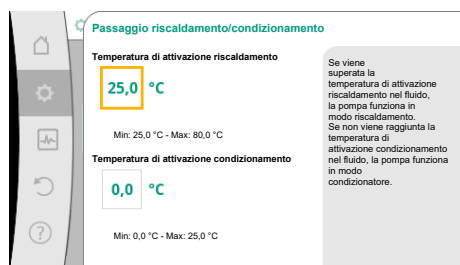
Fig. 52: Passaggio riscaldamento/condizionamento_Temperature di commutazione
