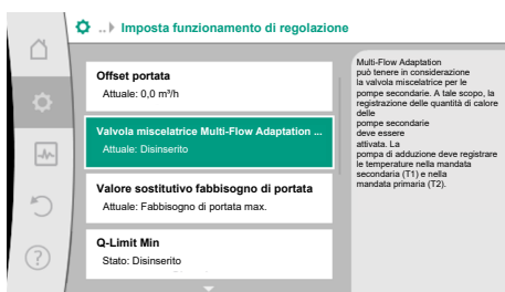
Fig. 60: Imposta funzionamento di regolazione: Valvola miscelatrice Multi-Flow Adaptation
