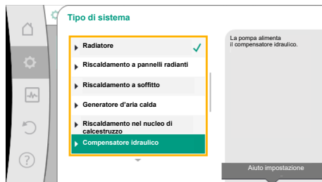
Fig. 55: Tipo di sistema “Compensatore idraulico”
