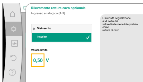
Fig. 79: Valore limite rottura di cavo
