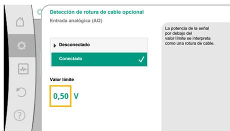
Fig. 79: Valor límite de rotura de cable
