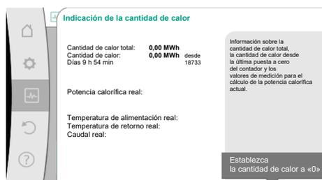
Fig. 94: Indicación de la cantidad de calor
