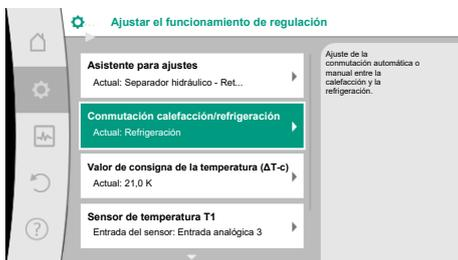
Fig. 48: Conmutación calefacción/refrigeración
