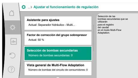
Fig. 58: Asistente de ajustes: selección de bombas secundarias
