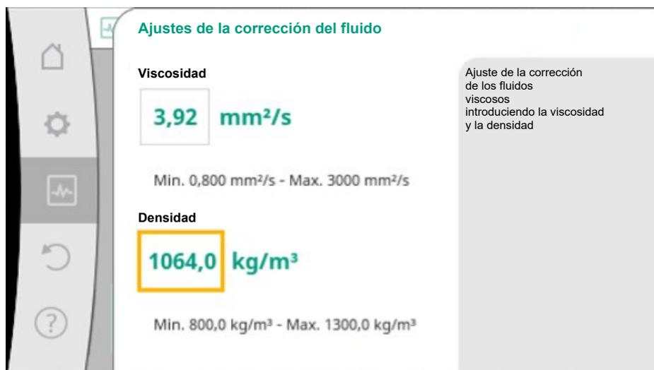
Fig. 98: Ajuste de viscosidad y densidad
