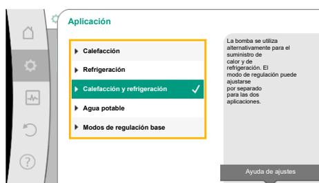
Fig. 46: Selección de aplicación «Calefacción y refrigeración»
