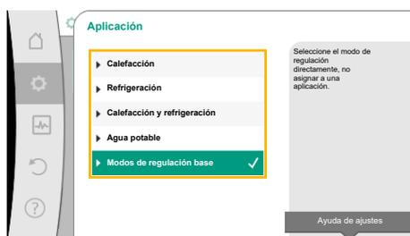
Fig. 45: Selección de aplicación «Modos de regulación base»
