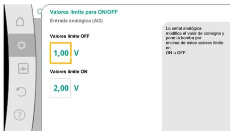
Fig. 81: Valores límite para conexión y desconexión a través de señal analógica
