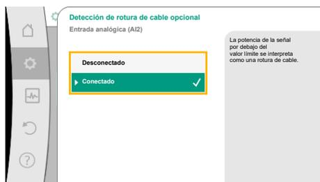
Fig. 78: Detección de rotura de cable opcional
