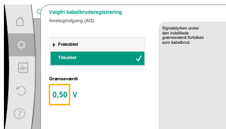
Fig. 79: Grænseværdi for kabelbrud
