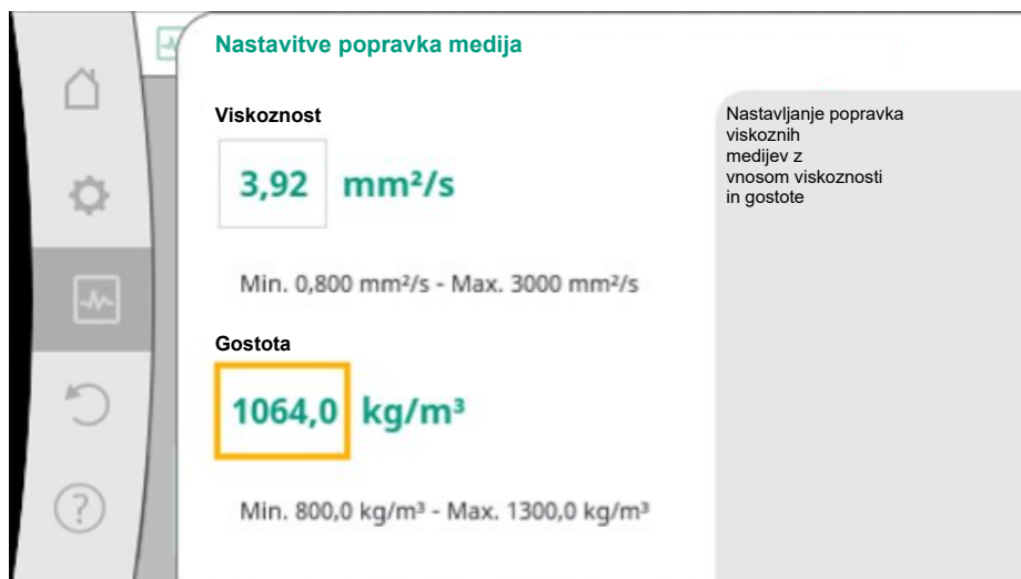
Fig. 98: Nastavitve viskoznosti in gostote
