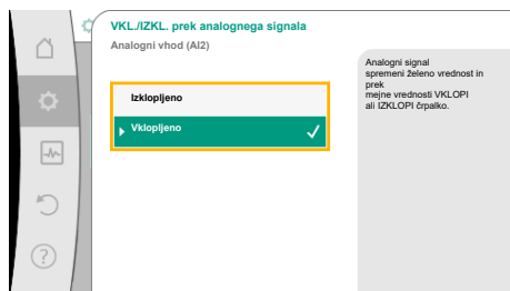
Fig. 80: Vkllop/izklop preko analognega signala
