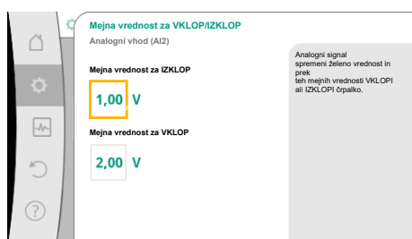
Fig. 81: Mejne vrednosti za krmiljenje VKL./IZKL. prek analognih signalov
