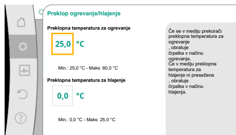
Fig. 52: Preklop ogrevanje/hlajenje_preklopne temperature
