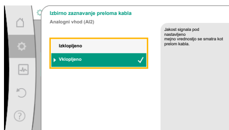
Fig. 78: Izbirno zaznavanje preloma kabla
