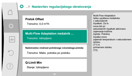
Fig. 60: Nastavitev regulacijskega obratovanja: Multi-Flow Adaptation mešalnik
