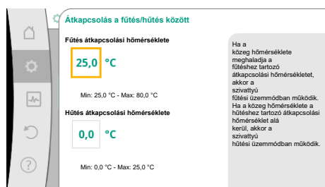
Fig. 52: Átkapcsolás a fűtés/hűtés között_Átkapcsolási hőmérsékletek
