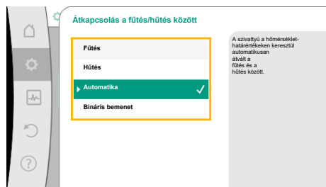
Fig. 51: Átkapcsolás a fűtés/hűtés között_Automatika
