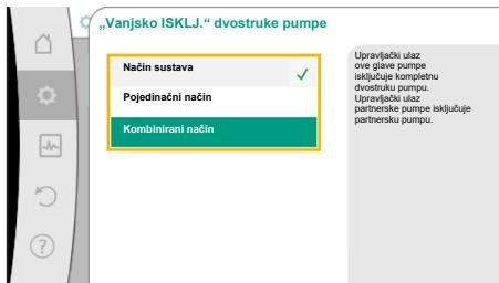
Fig. 66: Načini rada koji se mogu odabratи za EXT. OFF u slučaju dvostrukih pumpi
