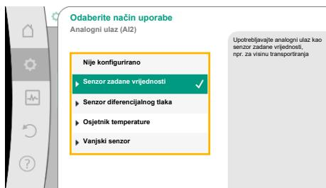
Fig. 69: Dijalog za postavljanje senzora zadane vrijednosti
