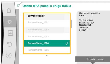
Fig. 59: Odabir sekundarnih pumpi za Multi-Flow Adaptation
