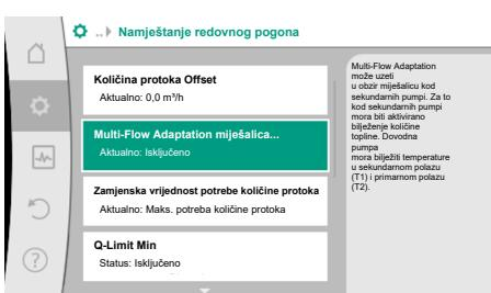
Fig. 60: Namještanje regulacijskog pogona: Multi-Flow Adaptation miješalica
