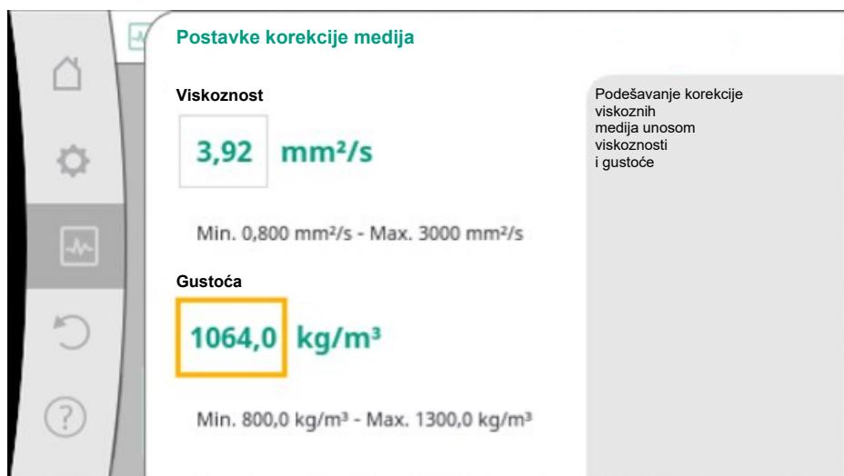
Fig. 98: Namještanje viskoznosti i gustoće
