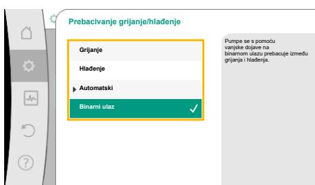
Fig. 53: Prebacivanje grijanje/hlađenje\_binarni ulaz
