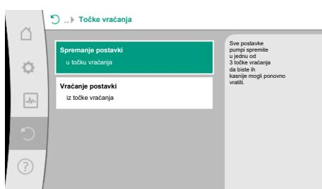
Kad je pumpa do kraja konfigurirana, npr. prilikom puštanja u pogon, namještena postavka se može spremiti. Ako je u međuvremenu provedena promjena postavki, spremljena postavka može se vratiti putem točaka vraćanja.
