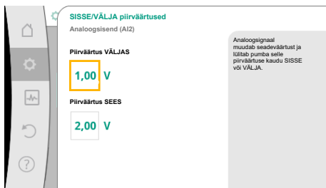
Fig. 81: SISSE/VÄLJA juhtimise piirväärtused analoogsignaali kaudu
