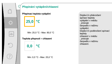
Fig. 52: Přepínání vytápění/chlazení_ teploty přepnutí
