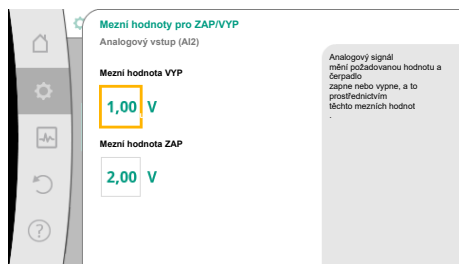
Fig. 81: Mezní hodnoty pro řízení zap/vyp prostřednictvím analogových signálů
