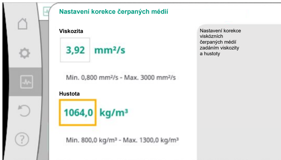
Fig. 98: Nastavení viskozity a hustoty
