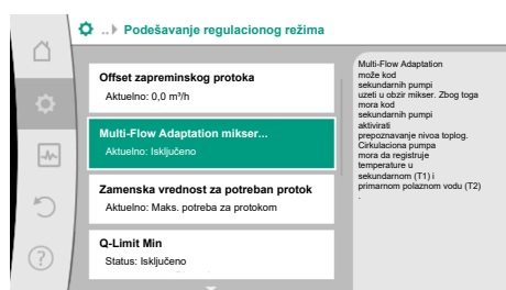
Fig. 60: Podešavanje regulacionog režima: Mikser Multi-Flow Adaptation
