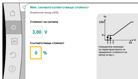
Fig. 82: Мин. сигнал/съответстваща стойност
