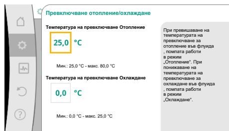
Fig. 52: Превключване отопление/охлаждане_температури на превключване
