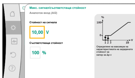
Fig. 83: Макс. сигнал/съответстваща стойност
