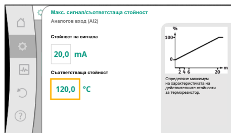
Fig. 88: Съпоставяне Макс. сигнал/стойност за сензор за действителна стойност
