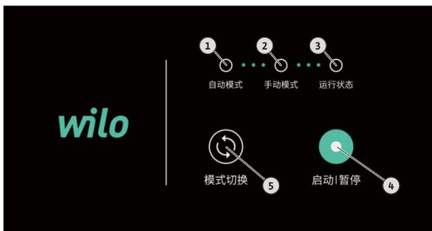
Fig. 3: PW BOOST OPTI操作面板
