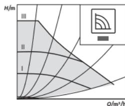
Recomendación para instalaciones con resistencia de sistema no modificable que requieren un caudal constante.
