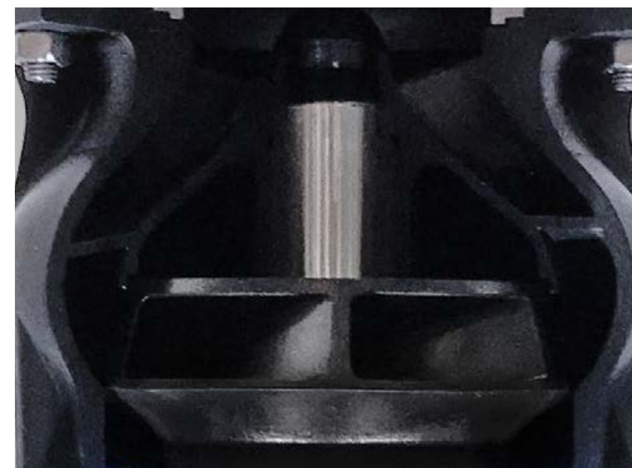
Pumpe mit starken Eisenoxidablagerungen
