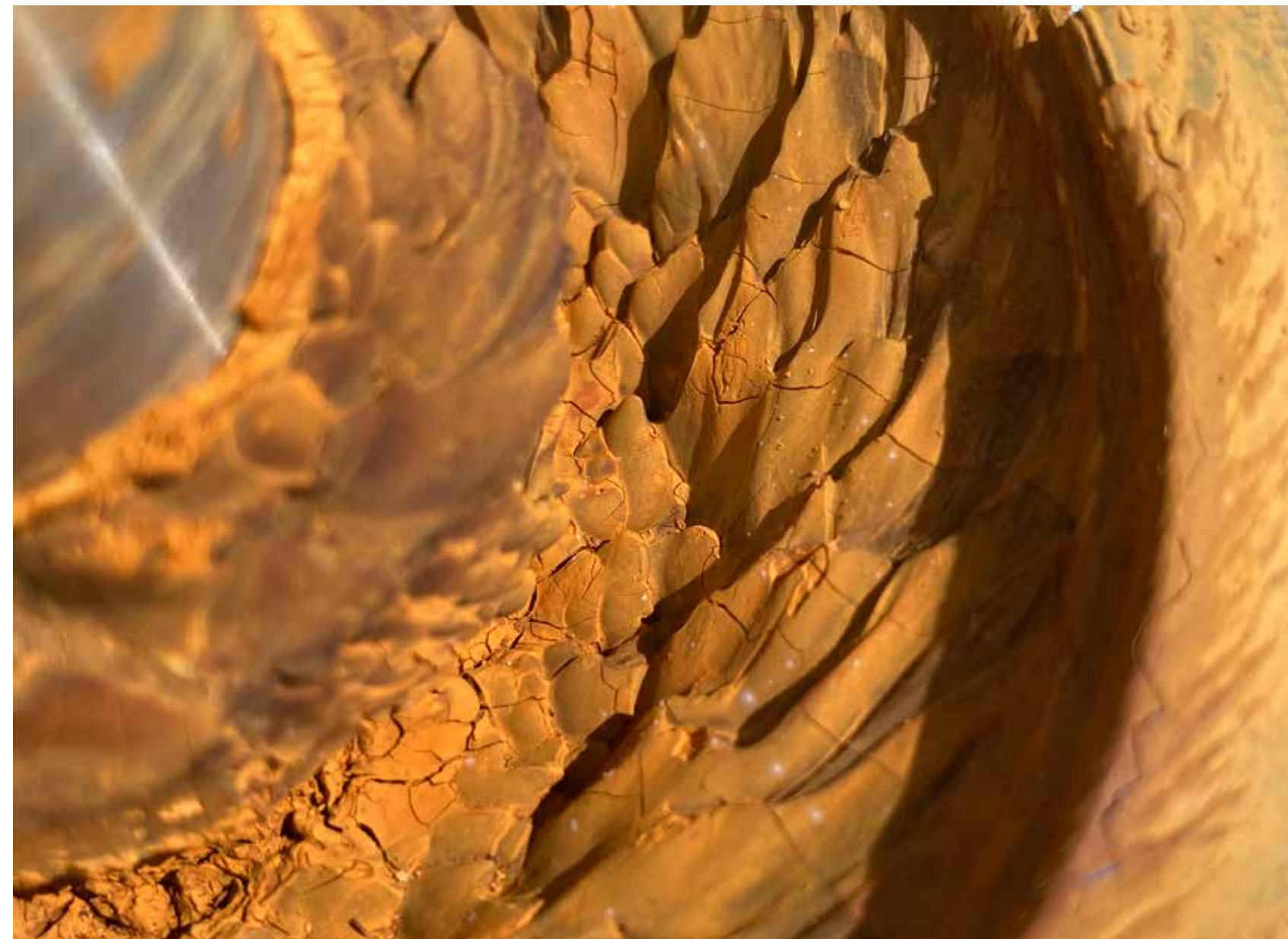
Pumpe mit starken Eisenoxidablagerungen
