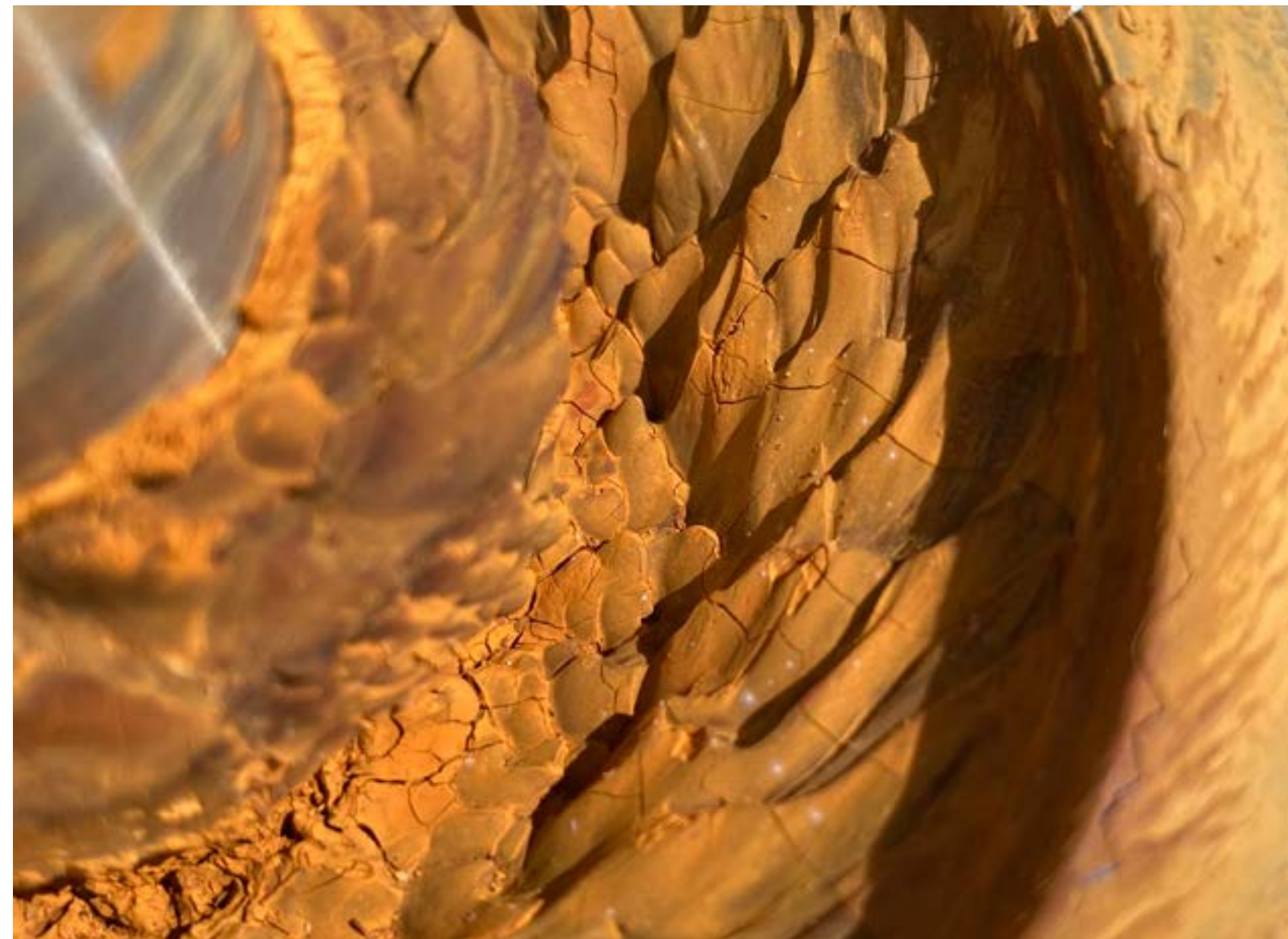
Pumpe mit starken Eisenoxidablagerungen
