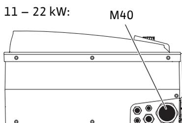
Fig. 24: Prensaestopas para el cable de alimentación eléctrica
