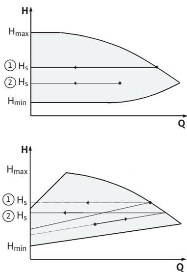
Fig. 32: Regulación Δp-c/Δp-v
