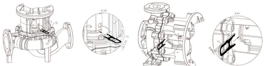
Horquilla de montaje para trabajos de ajuste
