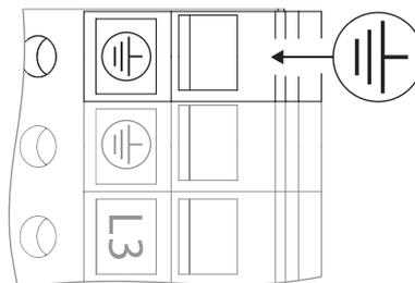
Fig. 28: Puesta a tierra adicional, potencia del motor a partir de 11 kW
