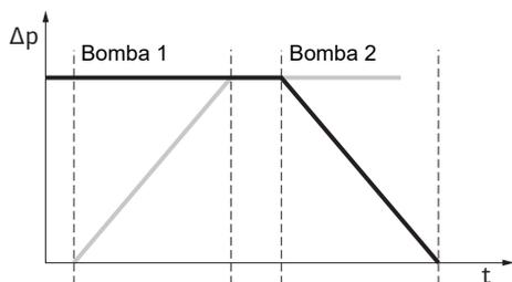
Fig. 11: Alternancia de bombas, de forma esquemática
