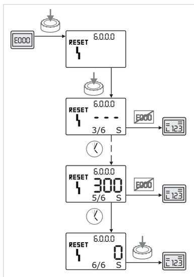
Fig. 56: Confirmación del tipo de fallo C
