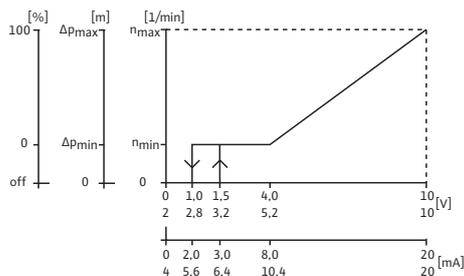
Fig. 12: Comportamiento de las salidas y entradas
