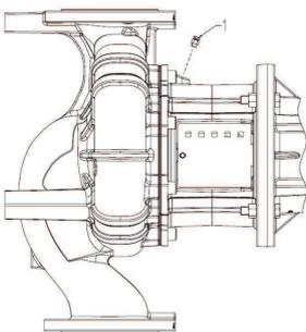
Fig. 30: Válvula de purga
