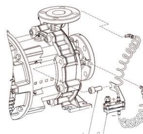
Tab. 14: Conexión de la sonda de presión diferencial
