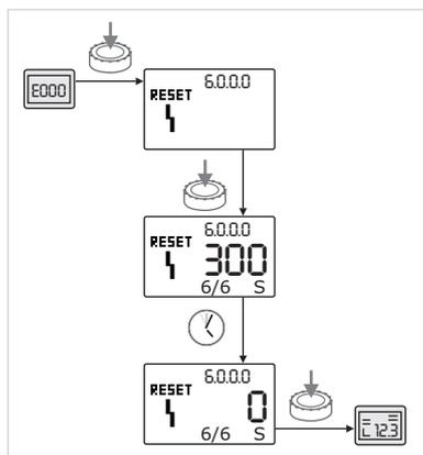
Fig. 54: Confirmación del tipo de fallo B (X=Y)
