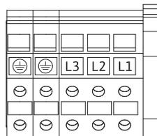
Fig. 27: Bornes de potencia
