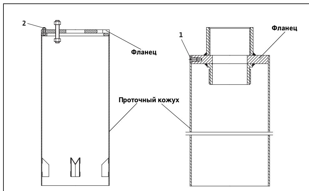
Рис. I-2: Проточный кожух установлен вертикально, заполнение после демонтажа
