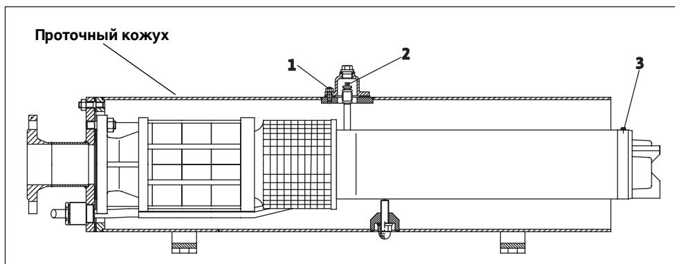
Рис. I-1: Проточный кожух установлен горизонтально, заполнение без демонтажа
