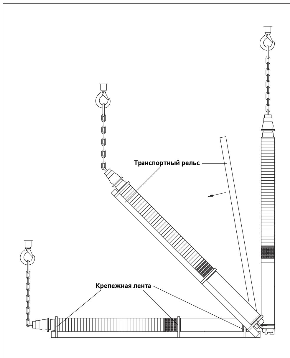
Рис. G-1: Длинное оборудование на транспортном редбсе
