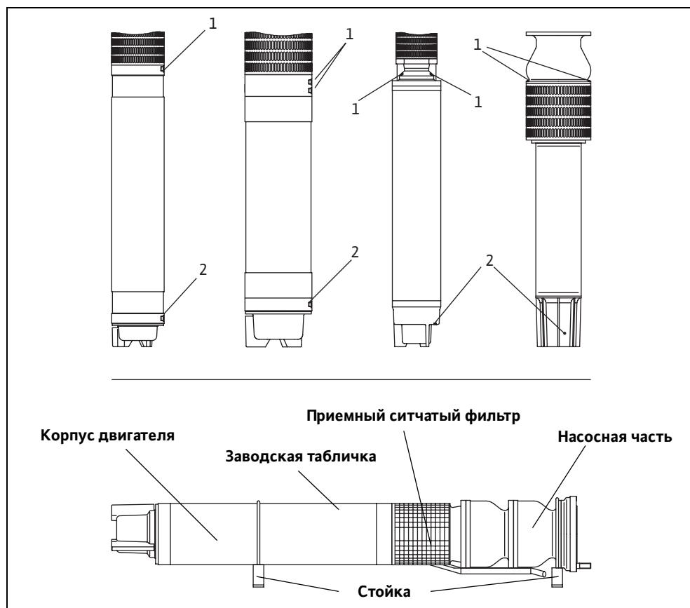
Рис. 5-1: Контроль и заполнение двигателя – вертикальный и горизонтальный монтаж
