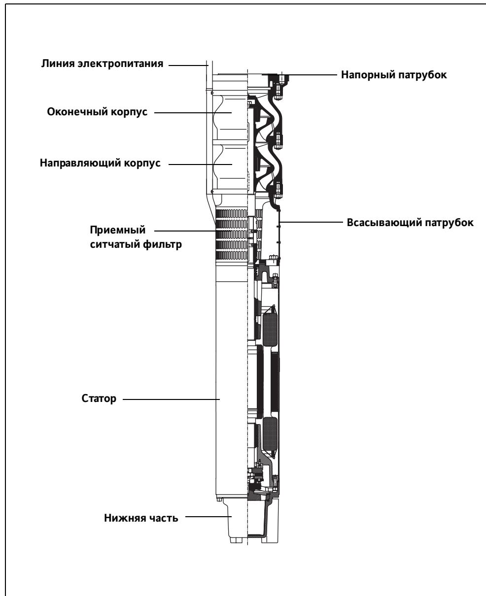
Рис. 3-1: Конструкция оборудования
