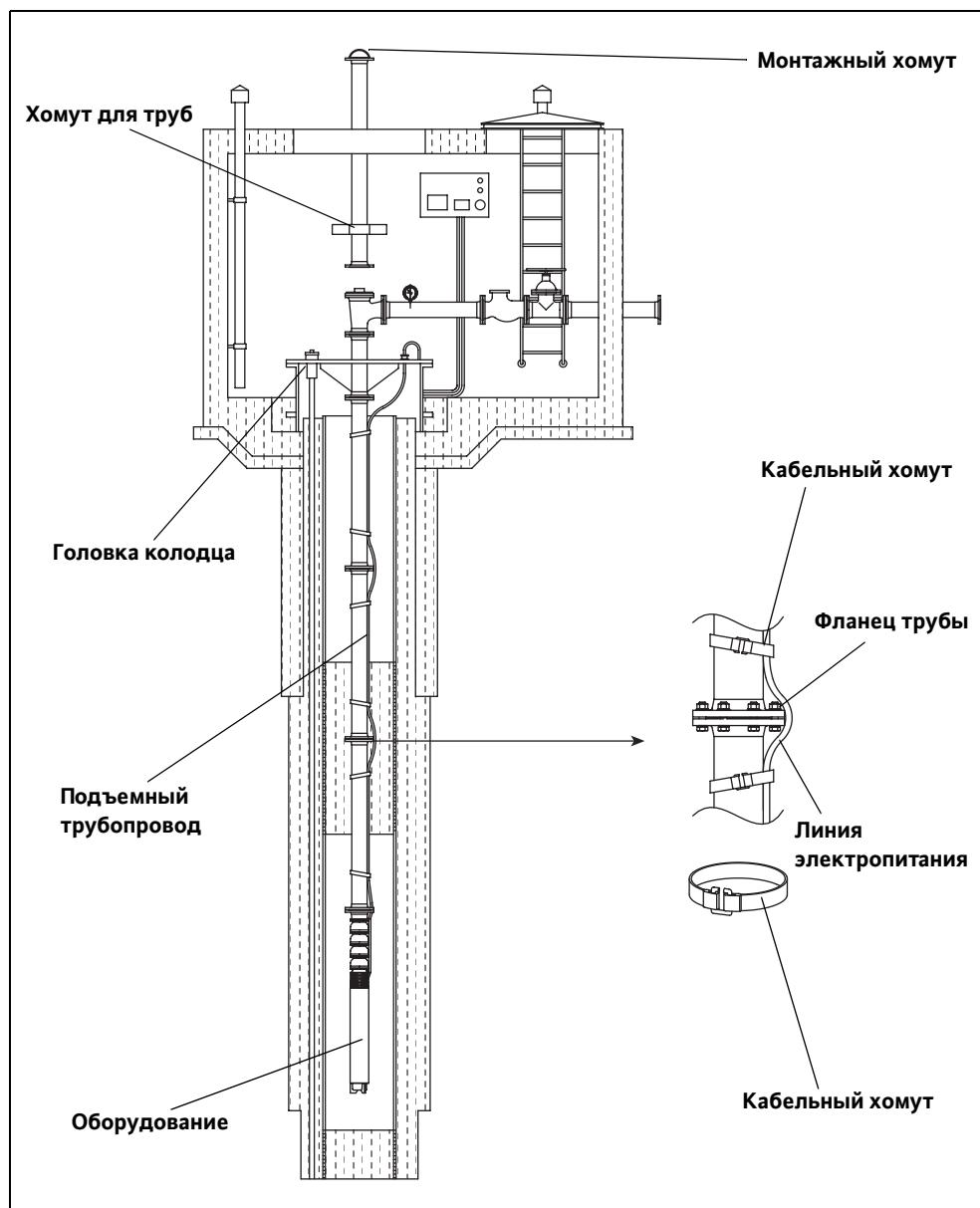
Рис. 5-2: Вертикальный монтаж
