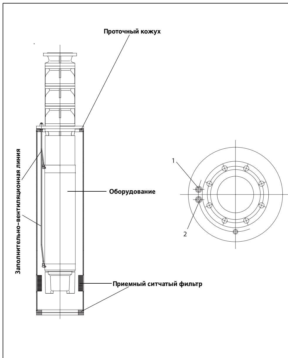
Рис. I-3: Проточный кожух установлен вертикально, заполнение без демонтажа
