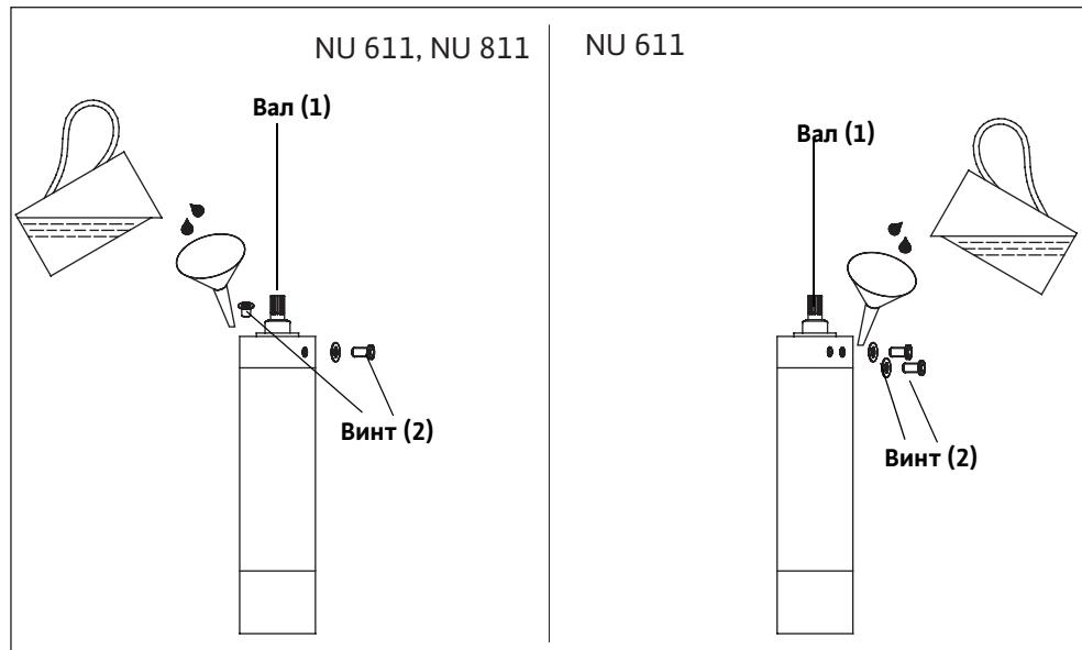
Рис. Е-1: Заполнение двигателя
