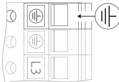
Fig. 28: Dodatno uzemljenje, od 11 kW snage motora
