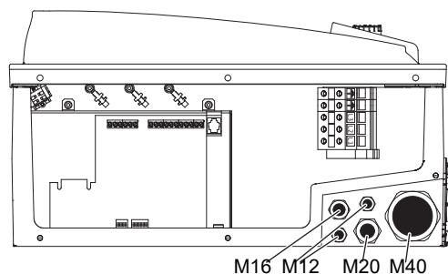
Fig. 29: Kabelske uvodnice
