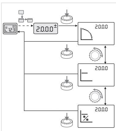
Fig. 45: Namještanje s povratkom na stranicu sa statusom
