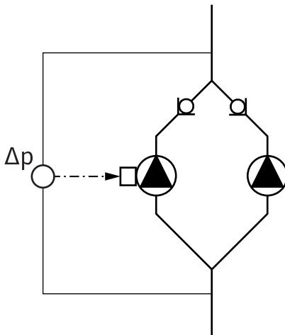
Fig. 9: Primjer – priklučak senzora diferencijalnog tlaka u instalacijama sa spojnicom
