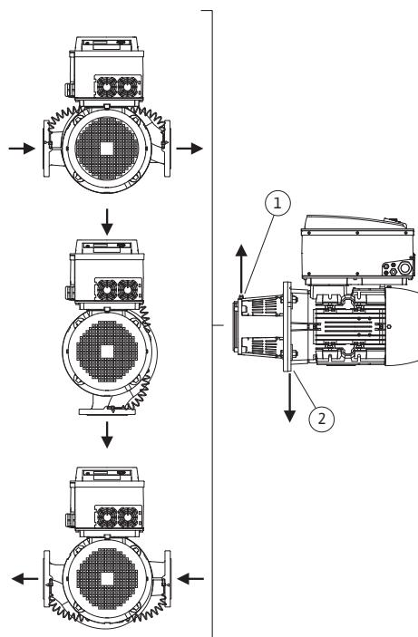
Fig. 14: Dopuseni položaji ugradnje s vodoravnim vratilom motora
