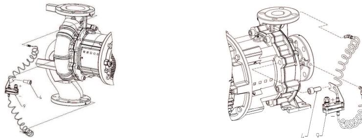
Tablica 14: Priključak senzora diferencijalnog tlaka
