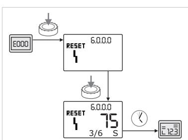
Fig. 55: Potvrda tipa pogreške B ( $X < Y$ )
