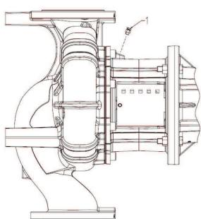
Fig. 30: Odzračni ventil
