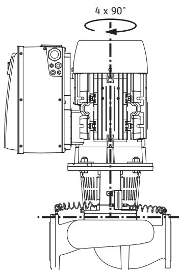
Fig. 17: Dopušteni položaji ugradnje s okomitim vratilom motora
