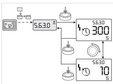
Fig. 44: Namještanje s povratkom na element izbornika „Odabir/postavke“
