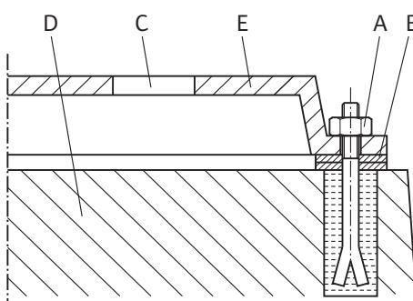
Fig. 16: Primjer vijčanog spoja za temelj
