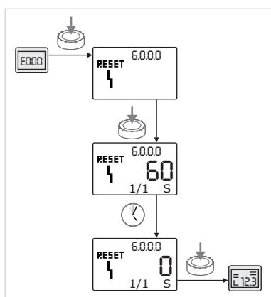
Fig. 53: Potvrda tipa pogreške A ili D
