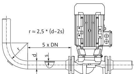
Fig. 18: Stabilizacijska dionica ispred i iza pumpe
