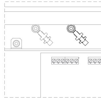
Fig. 25: Priklučivanje zakriljenosti
