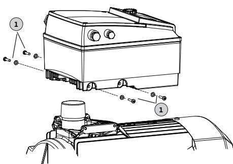
Fig. 49: Priključak električnog modula – motor
