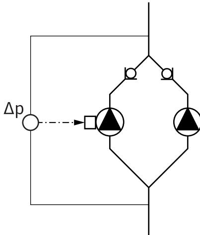
Fig. 9: 示例——Y型管道安装中压差传感器的连接
