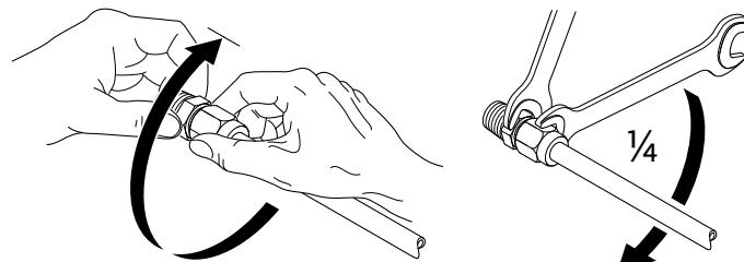
Fig. 19: 将夹紧环螺纹连接再转1/4圈
