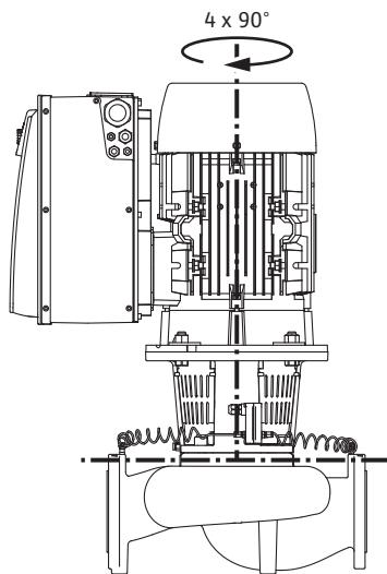
Fig. 17: 电机轴垂直时允许的安装位置
