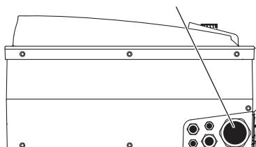
Fig. 24: 用于电源连接电缆的电缆螺纹接头
