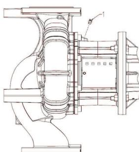
Fig. 30: 排气阀
