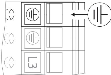
Fig. 28: 额外的接地, 11 kW以上的电机
