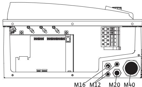
Fig. 29: 电缆螺纹连接
