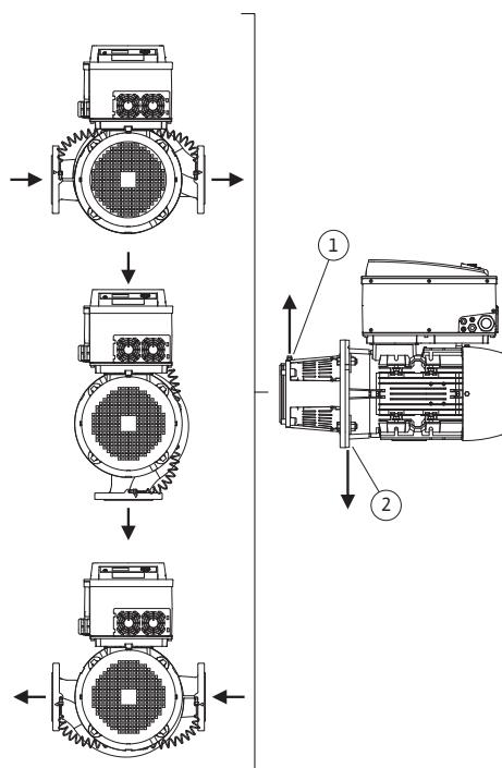
Fig. 14: 电机轴水平时允许的安装位置
