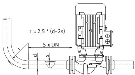
Fig. 18: 水泵前面、后面的稳定管段
