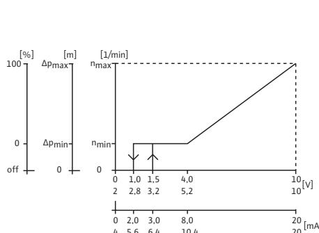
Fig. 12: 输入端和输出端的工作特性
