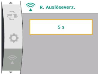
Die Auslösung des jeweiligen Signals nach Auftritt eines Fehlers, einer Warnung oder eines Betriebszustandes wird verzögert. Die Auslöse-Verzögerung lässt sich zwischen 0 ... 60 Sekunden einstellen.
