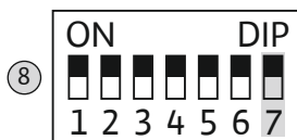
Fig. 16: DIP 开关 1：内部蜂鸣器
