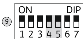
Fig. 18: DIP 开关 2：服务间隔显示
