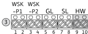
Fig. 13: 端子排传感器：高水位警报
