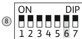
Fig. 17: DIP 开关 1：泵启动
