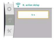
Сигнал после появления ошибки, предупреждения или изменения рабочего состояния выдается с задержкой. Возможный диапазон задержки выдачи сигнала: 0–60 се-
