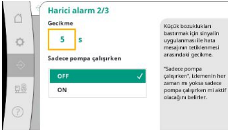
Fig. 60: İletişim → Alarmlar → Harici alarm 2/3 menü ögesi
