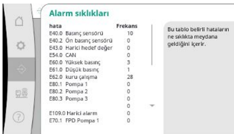
Fig. 58: İletişim → Alarmlar → Alarm sıklıkları menü ögesi
