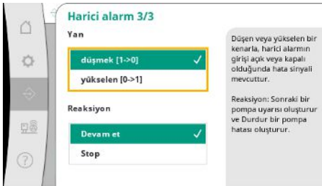
Fig. 61: İletişim → Alarmlar → Harici alarm 3/3 menü ögesi
