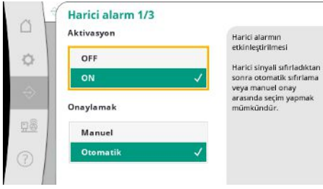
Fig. 59: İletişim → Alarmlar → Harici alarm 1/3 menü ögesi
