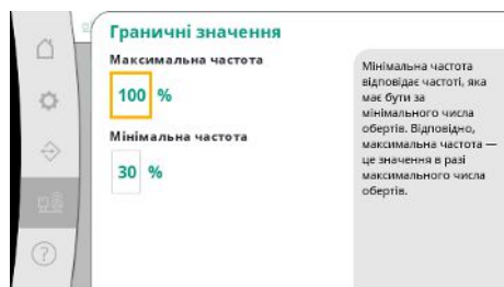
Fig. 100: Пункт меню Установка -> Частотний перетворювач -> Граничні значення
