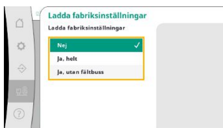
Fig. 110: Menypunkt System → Underhåll → Ladda fabriksinställningar
