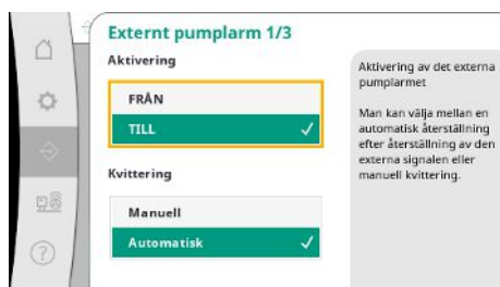
Fig. 62: Menypunkt Kommunikation → Larm → Externt pumplarm 1/3
