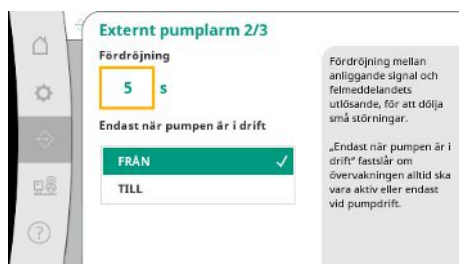
Fig. 63: Menypunkt Kommunikation → Larm → Externt pumplarm&nbsp;2/3
