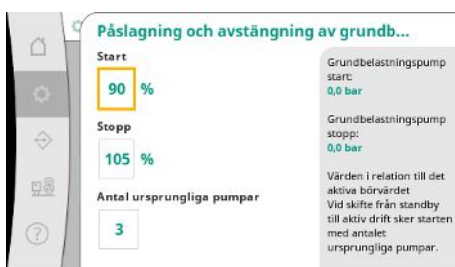
Fig. 24: Menypunkt inställningar → Börvärden → Påslagning och avstängning av grundbelastningspump
