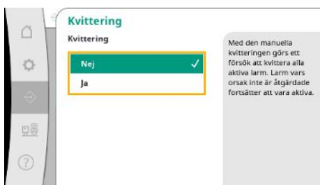
Fig. 56: Menypunkt kommunikation → Larm → Kvittering
