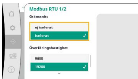
Fig. 77: Menypunkt Kommunikation → BMS → Modbus RTU 1
