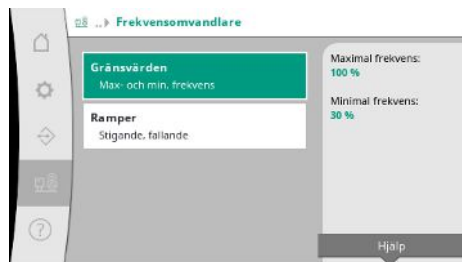
Fig. 99: Menypunkt System -> Frekvensomvandlare
