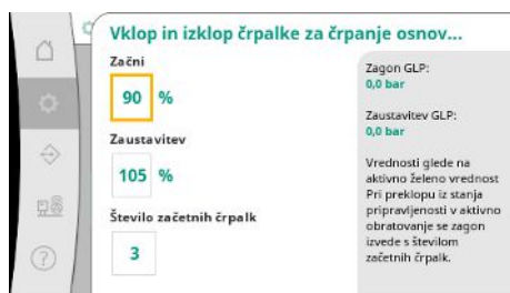
Fig. 24: Točka menija Nastavitve → Želene vrednosti → Vklon in izklop črpalke za črpanje osnovne količine (GLP)
