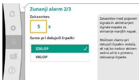
Fig. 60: Točka menija Komunikacija → Alarmi → Zunanji alarm 2/3
