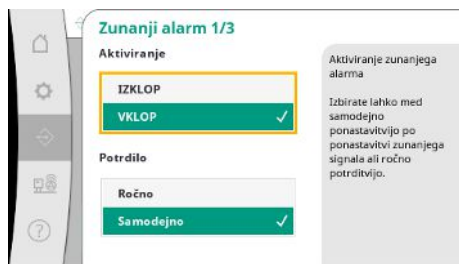
Fig. 59: Točka menija Komunikacija → Alarmi → Zunanji alarm 1/3
