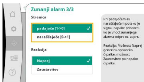
Fig. 61: Točka menija Komunikacija → Alarmi → Zunanji alarm 3/3
