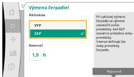
Fig. 45: Bod menu Nastavenia → Dodatočné nastavenia → Výmena čerpadiel
