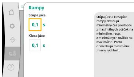
Fig. 101: Bod menu Systém → Frekvenčný menič → Rampy
