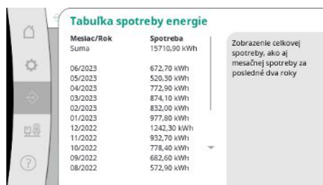
Fig. 70: Bod menu Komunikácia → Diagnostika a namerané hodnoty → Tabuľka spotreby energie
