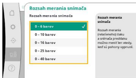
Fig. 94: Bod menu Systém → Snímače → Rozsah merania snímača
