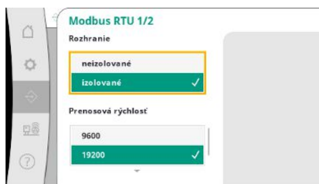
Fig. 77: Bod menu Komunikácia → BM-S → Modbus RTU 1
