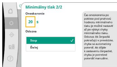
Fig. 35: Bod menu Nastavenia → Nastavenia monitorovania → Minimálny tlak 2/2
