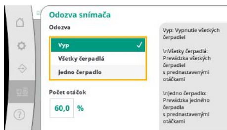
Fig. 96: Bod menu Systém → Snímače → Odozva snímača
