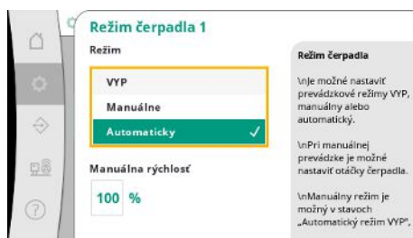
Fig. 20: Bod menu Nastavenia → Pripravenosť → Režim čerpadla 1
