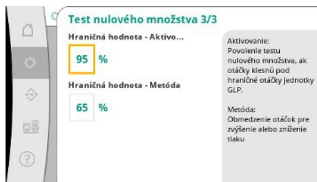
Fig. 50: Bod menu Nastavenia → Dodatočné nastavenia → Test nulového množstva &nbsp;3/3
