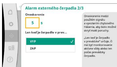
Fig. 63: Bod menu Komunikácia → Alarmy → Alarm externého čerpadla 2/3
