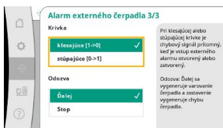
Fig. 64: Bod menu Komunikácia → Alarmy → Alarm externého čerpadla 3/3
