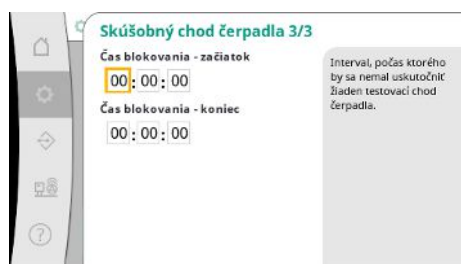
Fig. 44: Bod menu Nastavenia -> Dodatočné nastavenia -> Skúšobný chod čerpadla 3/3
