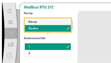
Fig. 78: Bod menu Komunikácia → BM-S → Modbus RTU 2
