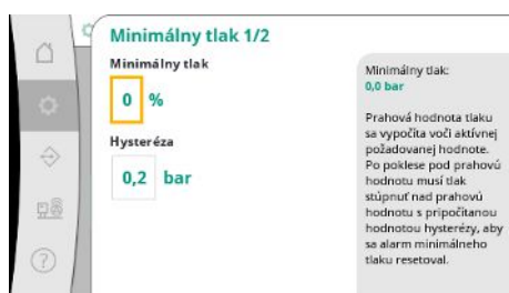
Fig. 34: Bod menu Nastavenia → Nastavenia monitorovania → Minimálny tlak 1/2
