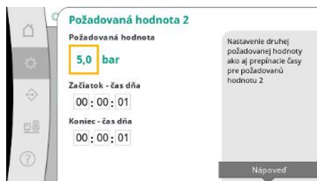
Fig. 23: Bod menu Nastavenia -> Požadované hodnoty -> Požadovaná hodnota 2
