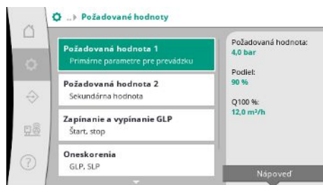
Fig. 21: Bod menu Nastavenia -> Požadované hodnoty -> Požadovaná hodnota 1
