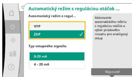
Fig. 46: Bod menu Nastavenia → Dodatočné nastavenia → Automatický režim s reguláciou otáčok 1/2
