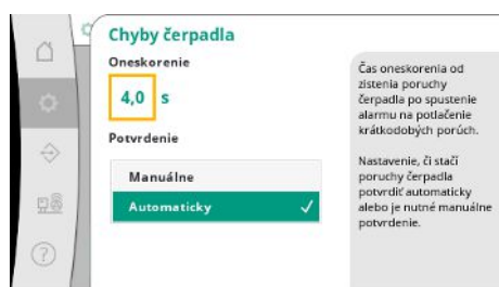
Fig. 38: Bod menu Nastavenia → Nastavenia monitorovania → Chyby čerpadla
