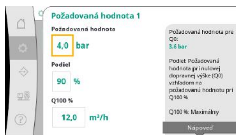
Fig. 22: Bod menu Nastavenia -> Požadované hodnoty -> Požadovaná hodnota 1
