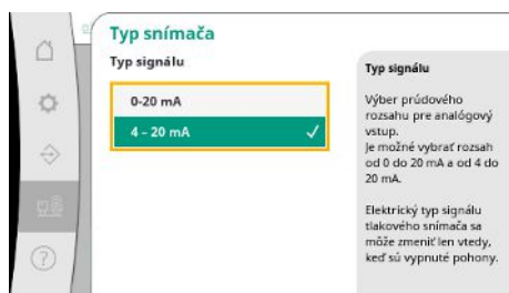
Fig. 98: Bod menu Systém → Snímače → Typ snímača
