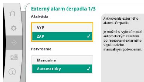
Fig. 62: Bod menu Komunikácia → Alarmy → Alarm externého čerpadla 1/3
