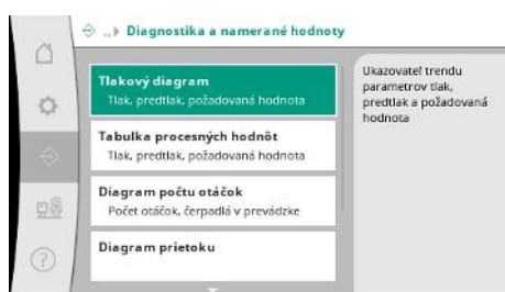
Fig. 65: Bod menu Komunikácia → Diagnostika a namerané hodnoty
