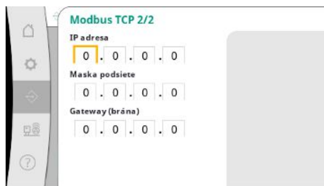
Fig. 76: Bod menu Komunikácia → BM-S → Modbus TCP 2
