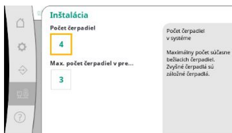
Fig. 88: Bod menu Systém → Čerpadlá → Inštalácia
