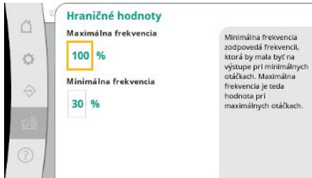
Fig. 100: Bod menu Systém → Frekvenčný menič → Hraničné hodnoty
