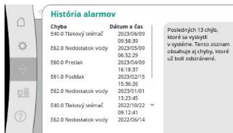
Fig. 57: Bod menu Komunikácia → Alarmy → História alarmov
