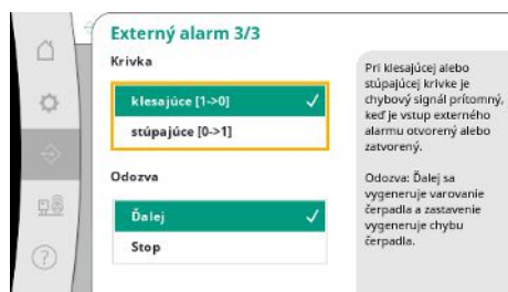
Fig. 61: Bod menu Komunikácia → Alarmy → Externý alarm 3/3
