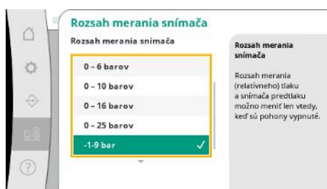
Fig. 97: Bod menu Systém → Snímače → Rozsah merania snímača
