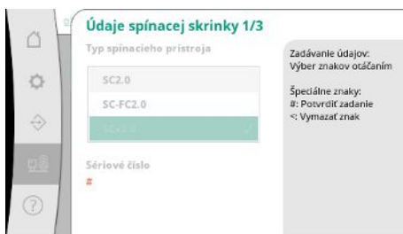
Fig. 103: Bod menu Systém → Údržba → Údaje spínacieho prístroja 1/3
