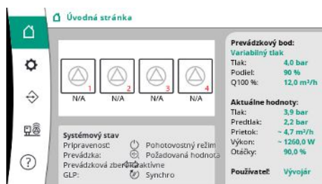
Fig. 16: Hlavná obrazovka v regulačnom režime p-v
