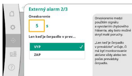
Fig. 60: Bod menu Komunikácia → Alarmy → Externý alarm 2/3
