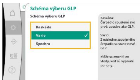
Fig. 30: Bod menu Nastavenia → Regulácia → Schéma výberu GLP
