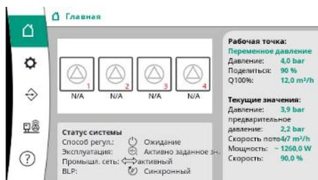
Fig. 16: Главный экран при способе регулирования р- $v$
