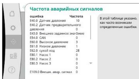
Fig. 58: Пункт меню Связь → Аварийные сигналы → Частота аварийных сигналов
