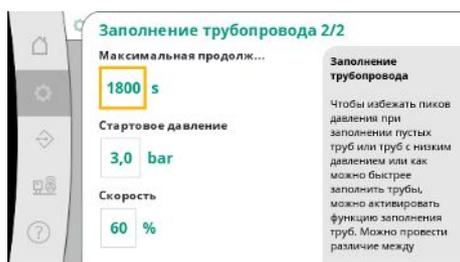
Fig. 52: Пункт меню Настройки → Дополнительные настройки → Функция наполнения трубы 2/2
