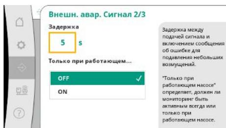
Fig. 60: Пункт меню Связь → Аварийные сигналы → Внешний аварийный сигнал 2/3
