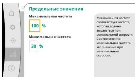
Fig. 100: Пункт меню Установка → Частотный преобразователь → Предельные значения
