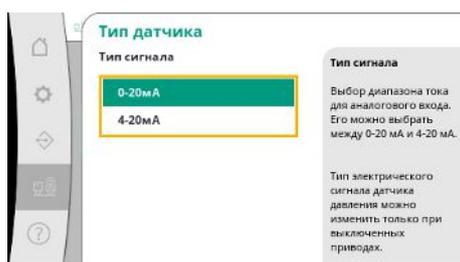
Fig. 95: Пункт меню Установка → Датчики → Тип датчика
