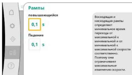
Fig. 101: Пункт меню Установка → Частотный преобразователь → Значения разгона
