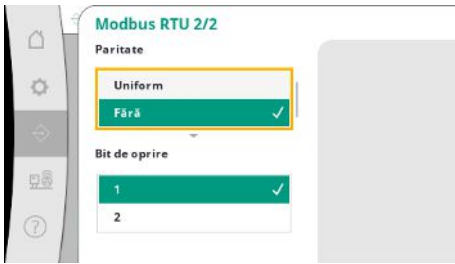
Fig. 78: Element de meniu Comunicare → BMS → Modbus RTU 2
