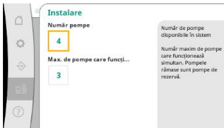
Fig. 88: Element de meniu Sistem → Pompe → Instalație
