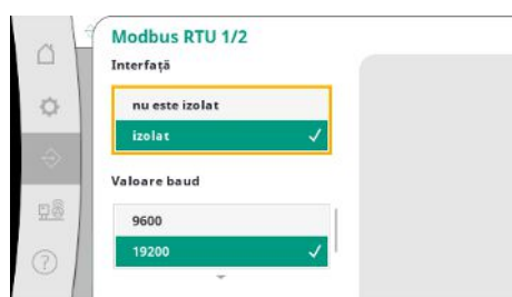
Fig. 77: Element de meniu Comunicare → BMS → Modbus RTU 1
