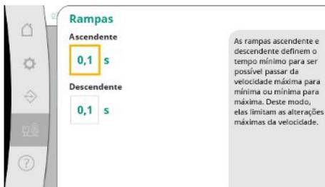
Fig. 101: Ponto de menu Sistema → Conversor de frequência → Rampas
