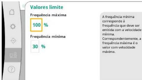
Fig. 100: Ponto de menu Sistema → Conversor de frequência → Valores limite
