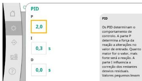
Fig. 29: Ponto de menu Regulações→Regulação→PID
