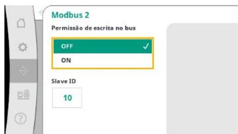
Fig. 74: Ponto de menu Comunicação -> BMS -> Modbus 2
