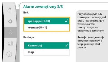
Fig. 61: Punkt menu Komunikacja → Alarmy → Alarm zewnętrzny 3/3
