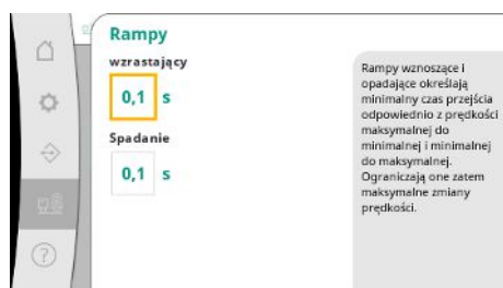
Fig. 101: Punkt menu System → Przetwornica częstotliwości → Rampy
