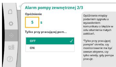
Fig. 63: Punkt menu Komunikacja → Alarmy → Zewnętrzny alarm pompy 2/3
