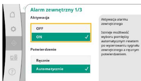
Fig. 59: Punkt menu Komunikacja → Alarmy- →Alarm zewnętrzny 1/3
