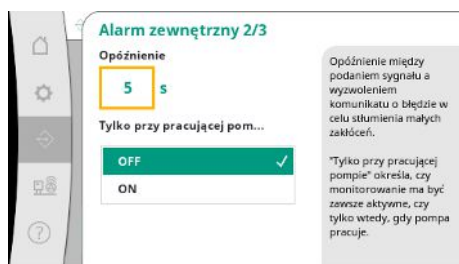
Fig. 60: Punkt menu Komunikacja → Alarmy- →Alarm zewnętrzny 2/3
