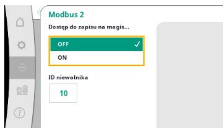
Fig. 74: Punkt menu Komunikacja -> BM-S -> Modbus 2
