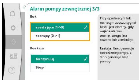
Fig. 64: Punkt menu Komunikacja → Alarmy → Zewnętrzny alarm pompy 3/3
