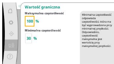
Fig. 100: Punkt menu System → Przetwornica częstotliwości → Wartości graniczne
