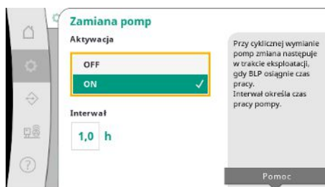
Fig. 45: Punkt menu Ustawienia → Dodatkowe ustawienia → Zamiana pomp
