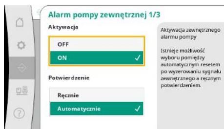
Fig. 62: Punkt menu Komunikacja → Alarmy → Zewnętrzny alarm pompy 1/3
