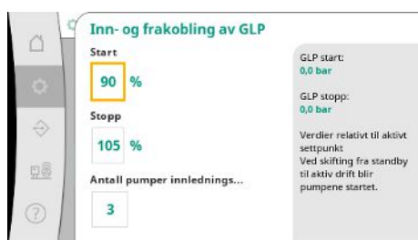
Fig. 24: Menypunktet Innstillinger → Settpunkter → Inn- og frakobling av GLP
