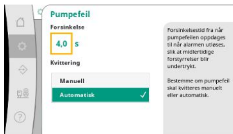
Fig. 38: Menypunktet Innstillinger → Overvåkningsinnstillinger → Pumpefeil
