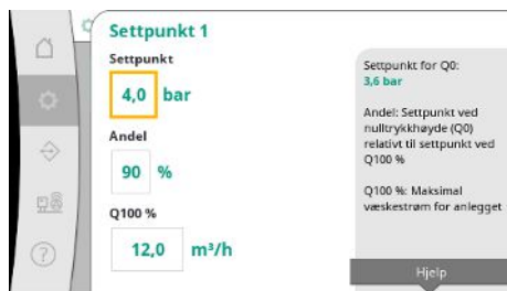
Fig. 22: Menypunktet Innstillinger → Settpunkter → Settpunkt 1
