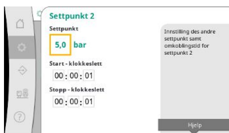
Fig. 23: Menypunktet Innstillinger → Settpunkter → Settpunkt 2
