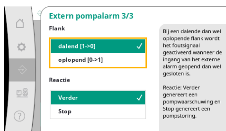
Fig. 64: Menupunt Communicatie → Alar- men → Extern pompalarm 3/3
