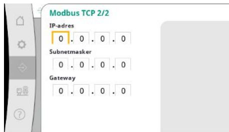
Fig. 76: Menupunt Communicatie → GBS → Modbus TCP 2
