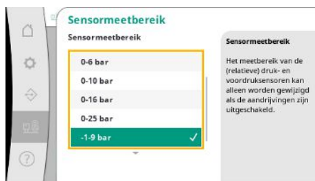
Fig. 97: Menupunt Installatie → Sensoren → – Sensormeeetbereik
