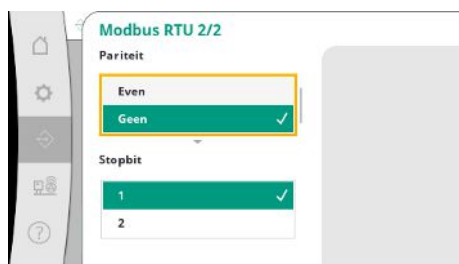
Fig. 78: Menupunt Communicatie → GBS → Modbus RTU 2
