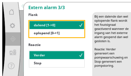
Fig. 61: Menupunt Communicatie → Alar- men → Extern alarm 3/3
