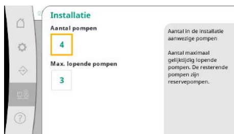
Fig. 88: Menupunt Installatie → Pompen → Installatie
