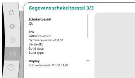
Fig. 105: Menupunt Installatie → Onderhoud → Gegevens schakelkast 3/3
