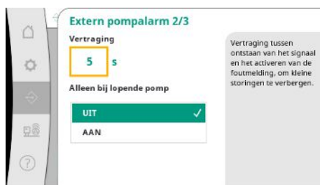
Fig. 63: Menupunt Communicatie → Alar- men → Extern pompalarm 2/3
