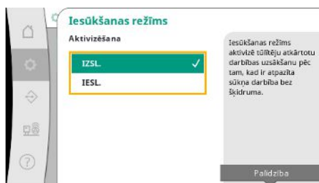
Fig. 41: Izvēlnes elements Iestatījumi → Papildu iestatījumi → Iesūkšanas režīms
