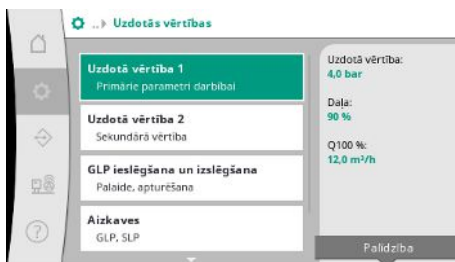
Fig. 21: Izvēlnes elements Iestatījumi → Uzdotās vērtības → 1. uzdotā vērtība
