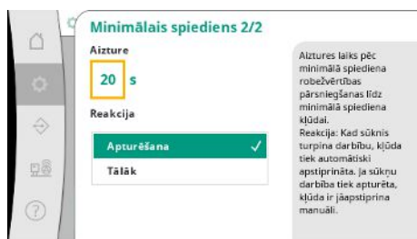
Fig. 35: Izvēlnes elements Iestatījumi → Kontroles Iestatījumi → Minimālais spiediens 2/2
