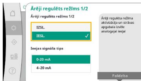
Fig. 46: Izvēlnes elements Iestatījumi → Papildu iestatījumi → Ārēji regulēts režīms 1/2
