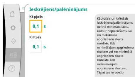
Fig. 101: Izvēlnes elements Iekārta -> Frekvences pārveidotājs -> Rampas
