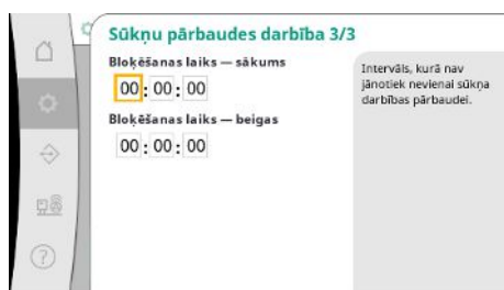
Fig. 44: Izvēlnes elements Iestatījumi → Papildu iestatījumi → Sūkņu pārbaudes darbība 3/3
