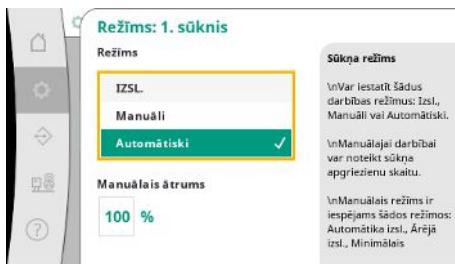
Fig. 20: Izvēlnes elements Iestatījumi → Gatavība → 1. sūkņa režīms
