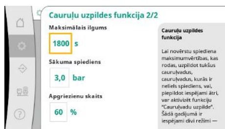
Fig. 52: Izvēlnes elements Iestatījumi → Papildu iestatījumi → Cauruļu uzpildes funkcija 2/2
