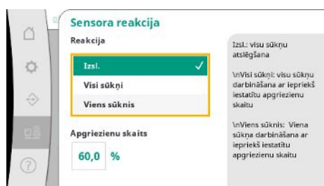
Fig. 96: Izvēlnes elements Iekārta → Sensori → Sensora reakcija
