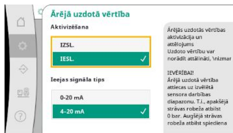
Fig. 26: Izvēlnes elements Iestatījumi → Uzdotās vērtības → Ārējā uzdotā vērtība
