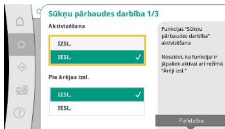
Fig. 42: Izvēlnes elements Iestatījumi → Papildu iestatījumi → Sūkņu pārbaudes darbība 1/3
