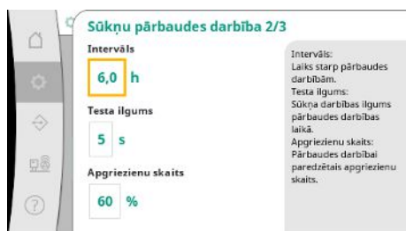
Fig. 43: Izvēlnes elements Iestatījumi → Papildu iestatījumi → Sūkņu pārbaudes darbība 2/3
