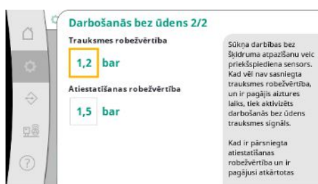
Fig. 37: Izvēlnes elements Iestatījumi → Kontroles Iestatījumi → Darbība bez ūdens 2/2
