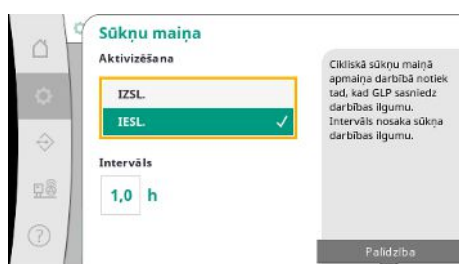
Fig. 45: Izvēlnes elements Iestatījumi → Papildu iestatījumi → Sūkņa nomaiņa
