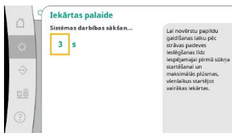
Fig. 39: Izvēlnes elements Iestatījumi → Kontroles iestatījumi → Iekārtas startēšana
