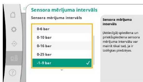
Fig. 97: Izvēlnes elements Iekārta → Sensori → Sensoru mērīšanas zona
