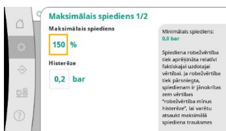
Fig. 32: Regulēšanas iestatījumi → Kontroles iestatījumi → Maksimālais spiediens 1/2
