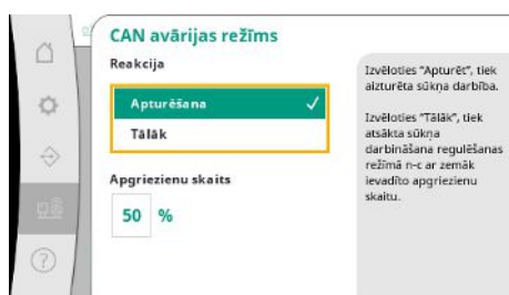
Fig. 91: Izvēlnes elements Iekārta → Sūkņi → CAN avārijas režīms
