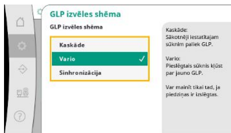
Fig. 30: Izvēlnes elements Iestatījumi → Regulēšana → GLP izvēles shēma
