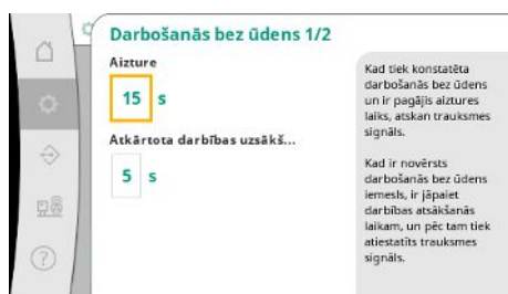
Fig. 36: Izvēlnes elements Iestatījumi → Kontroles Iestatījumi → Darbība bez ūdens 1/2
