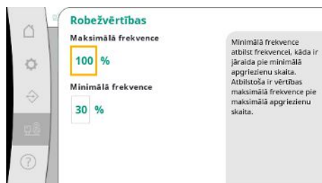
Fig. 100: Izvēlnes elements Iekārta -> Frekvences pārveidotājs -> Robežvērtības
