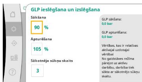
Fig. 24: Izvēlnes elements Iestatījumi → Uzdotās vērtības → GLP ieslēgšana un izslēgšana
