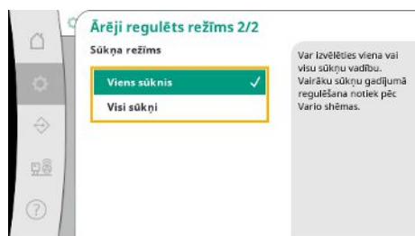
Fig. 47: Izvēlnes elements Iestatījumi → Papildu iestatījumi → Ārēji regulēts režīms 2/2
