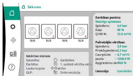
Fig. 16: Galvenais ekrāns regulēšanas režīmā p-v
