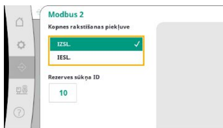
Fig. 74: Izvēlnes elements Komunikācija → BMS → Modbus 2
