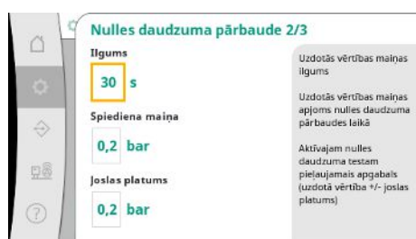
Fig. 49: Izvēlnes elements Iestatījumi → Papildu iestatījumi → Nulles daudzuma pārbaude 2/3
