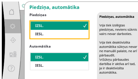
Fig. 19: Izvēlnes elements Iestatījumi → Gatavība → Piedziņa, automātika
