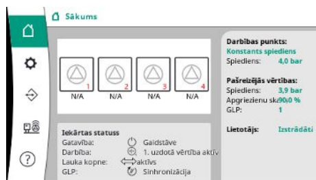
Fig. 17: Galvenais ekrāns regulēšanas režīmā p-c
