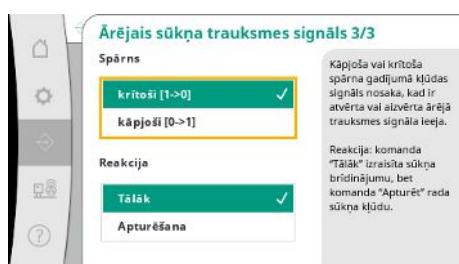
Fig. 64: Izvēlnes elements Komunikācija → Trauksmes → Ārēja sūkņa trauksme &nbsp;3/3
