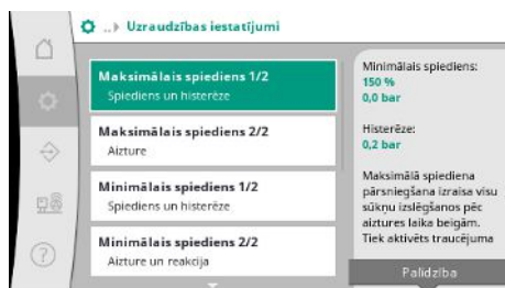
Fig. 31: Izvēlnes elements Regulēšanas iestatījumi → Kontroles iestatījumi
