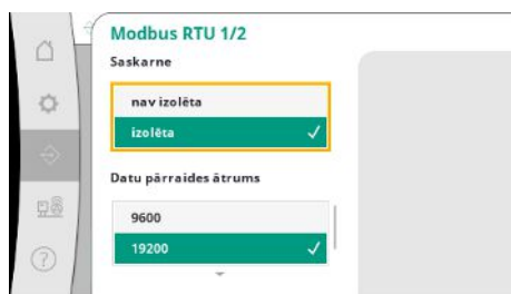
Fig. 77: Izvēlnes elements Komunikācija → BMS → Modbus RTU 1
