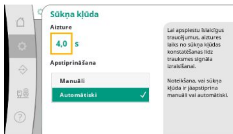
Fig. 38: Izvēlnes elements Iestatījumi → Kontroles iestatījumi → Sūkņa kļūda
