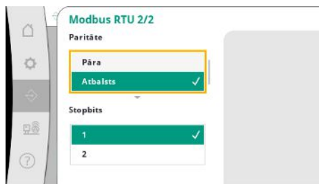
Fig. 78: Izvēlnes elements Komunikācija → BMS → Modbus RTU 2
