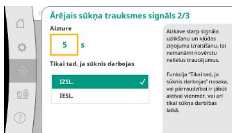
Fig. 63: Izvēlnes elements Komunikācija → Trauksmes → Ārēja sūkņa trauksme &nbsp;2/3
