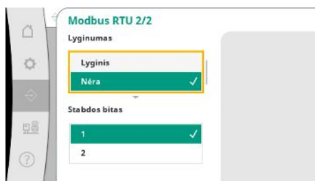
Fig. 78: Meniu punktas Ryšys → BMS → Modbus RTU 2
