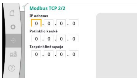
Fig. 76: Meniu punktas Ryšys → BMS → Modbus TCP 2
