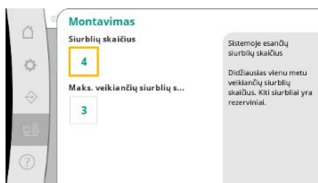
Fig. 88: Meniu punktas Sistema → Siurbliai → Instaliavimas
