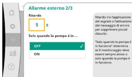
Fig. 60: Voce di menu Comunicazione → Allarmi → Allarme esterno 2/3
