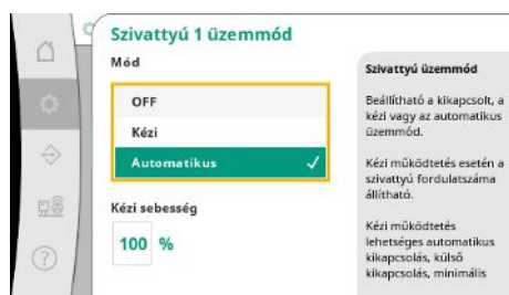
Fig. 20: Beállítások menüpont -> készenlét -> 1. szivattyú üzemmód
