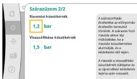
Fig. 37: Beállítások menüpont → felügyeleti beállítások → szárázonfutás 2/2
