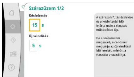
Fig. 36: Beállítások menüpont → felügyeleti beállítások → szárázonfutás 1/2
