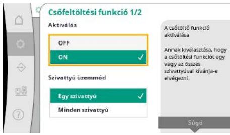
Fig. 51: Szabályozási beállítások → további beállítások → csőtöltő funkció 1/2
