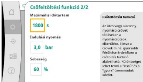
Fig. 52: Szabályozási beállítások → további beállítások → csőtöltő funkció 2/2
