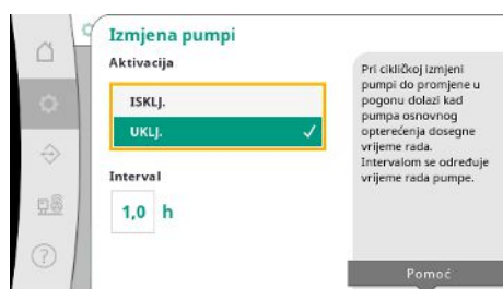
Fig. 45: Stavka izbornika Postavke → Dodatne postavke → Izmjena pumpi
