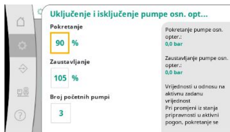
Fig. 24: Stavka izbornika Postavke → Zadane vrijednosti → Uključenje i isključenje pumpe osn. opter.
