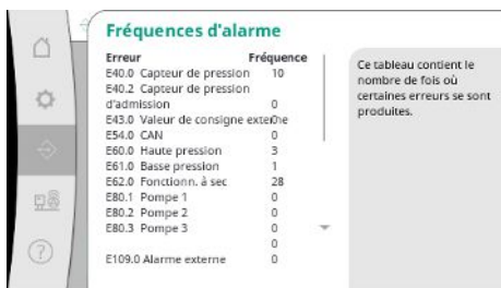
Fig. 58: Élément du menu Communication → Alarmes → Fréquences des alarmes
