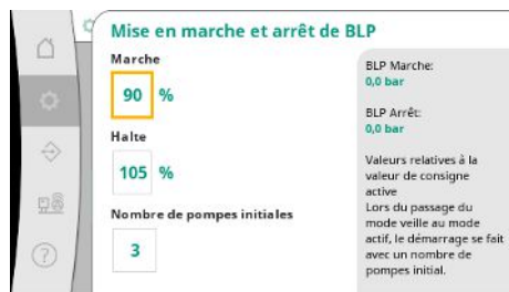
Fig. 24: Élément du menu Réglages → Consignes → Mise en marche et arrêt de la pompe principale
