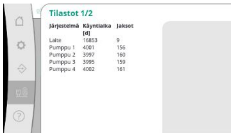
Fig. 89: Valikkokohta Järjestelmä -> Pumput -> Tilastot 1/2
