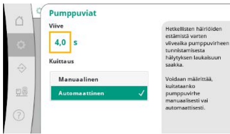
Fig. 38: Valikkokohta Asetukset → Valvonta-asetukset → Pumppuvirhe
