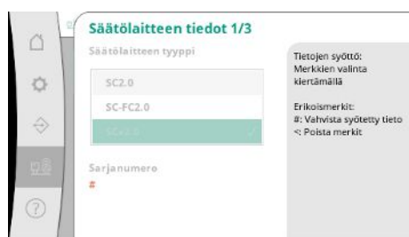
Fig. 103: Valikkokohta Järjestelmä → Huolto → Säätölaitteen tiedot 1/3
