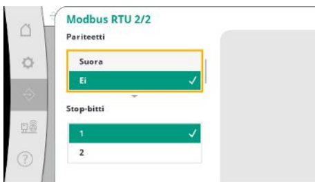
Fig. 78: Valikkokohta Tiedonvaihto → BMS → Modbus RTU 2
