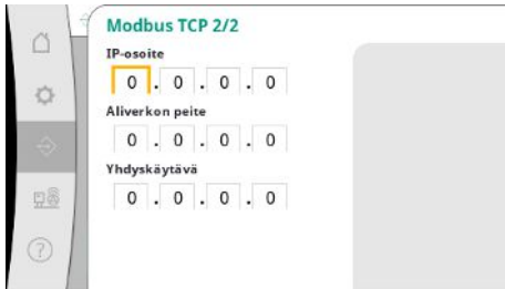
Fig. 76: Valikkokohta Tiedonvaihto → BMS → Modbus TCP 2
