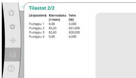
Fig. 90: Valikkokohta Järjestelmä -> Pumput -> Tilastot 2/2
