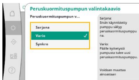
Fig. 30: Valikkokohta Asetukset → Säätö → Peruskuormituspumppun valintakaavio
