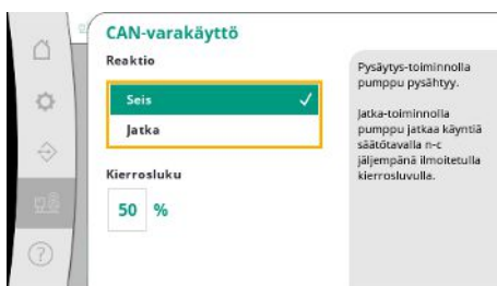
Fig. 91: Valikkokohta Järjestelmä -> Pumput -> CAN-varakäyttö
