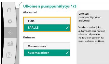
Fig. 62: Valikkokohta Tiedonvaihto → Hälytykset → Ulkoisen pumppuhälytys 1/3
