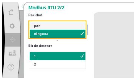
Fig. 78: Opción de menú Comunicación → BMS → Modbus RTU 2
