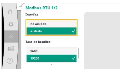
Fig. 77: Opción de menú Comunicación → BMS → Modbus RTU 1
