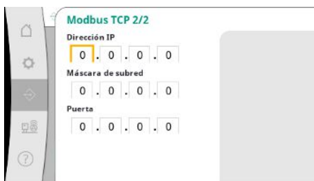
Fig. 76: Opción de menú Comunicación → BMS → Modbus TCP 2
