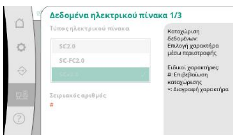
Fig. 103: Στοιχείο μενού System → Συντήρηση → Δεδομένα ηλεκτρικού πίνακα 1/3
