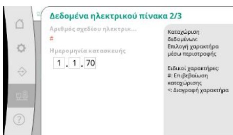
Fig. 104: Στοιχείο μενού System → Συντήρηση → Δεδομένα ηλεκτρικού πίνακα 2/3
