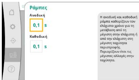
Fig. 101: Στοιχείο μενού System → Μετατροπέας συχνότητας → Ράμπες
