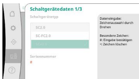
Fig. 103: Menüpunkt System -> Wartung -> Schaltgerätedaten 1/3
