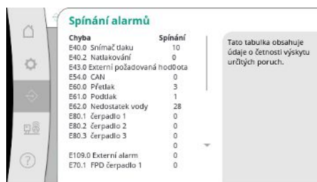
Fig. 58: Bod menu Komunikace → Alarmy → Spínání alarmů
