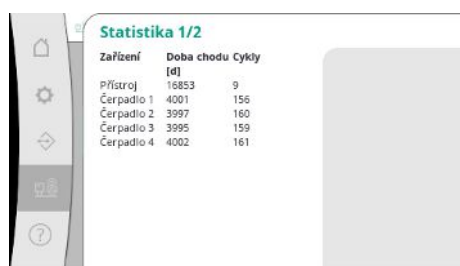
Fig. 89: Položka menu Systém → Čerpadla → Statistika 1/2
