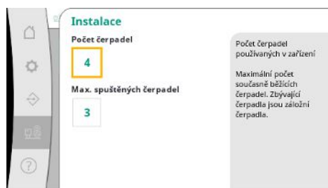
Fig. 88: Bod menu Systém → Čerpadla → Instalace
