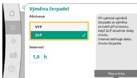
Fig. 45: Bod menu Nastavení → Dodatečné nastavení → Výměna čerpadla
