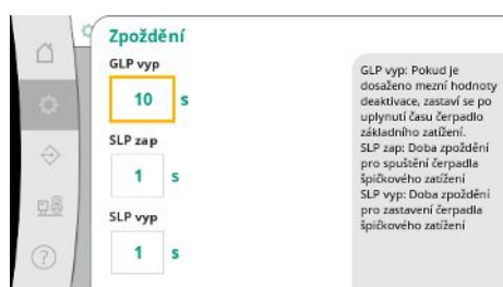
Fig. 25: Bod menu Nastavení → Požadované hodnoty → Zpoždění
