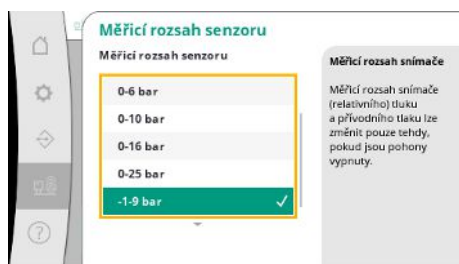
Fig. 97: Bod menu Systém → Sensory → Měřicí rozsah snímače
