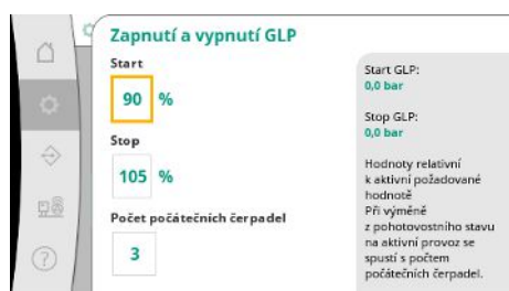
Fig. 24: Bod menu Nastavení → Požadované hodnoty → Zapnutí a vypnutí GLP
