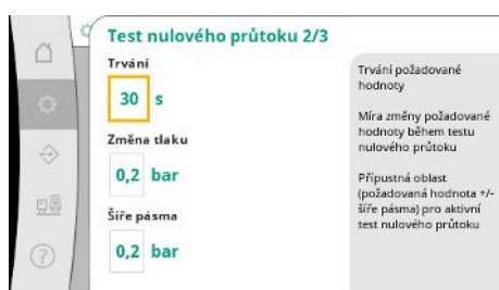
Fig. 49: Bod menu Nastavení → Dodatečné nastavení → Test nulového průtoku 2/3
