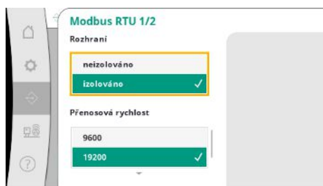
Fig. 77: Bod menu Komunikace → BMS → Modbus RTU 1
