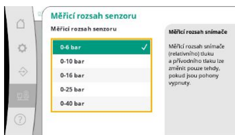
Fig. 94: Bod menu Systém → Senzory → Měřicí rozsah snímače
