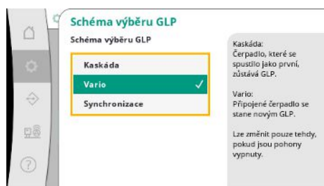
Fig. 30: Bod menu Nastavení → Regulace → Schéma výběru GLP
