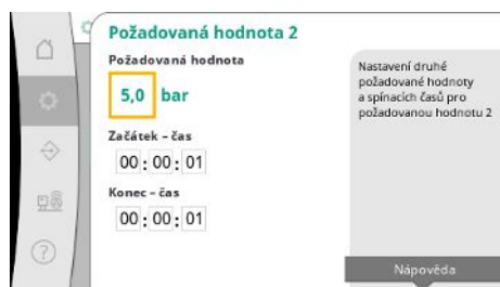
Fig. 23: Bod menu Nastavení → Požadované hodnoty → Požadovaná hodnota 2
