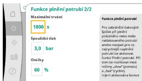
Fig. 52: Bod menu Nastavení → Dodatečné nastavení → Funkce plnění potrubí 2/2
