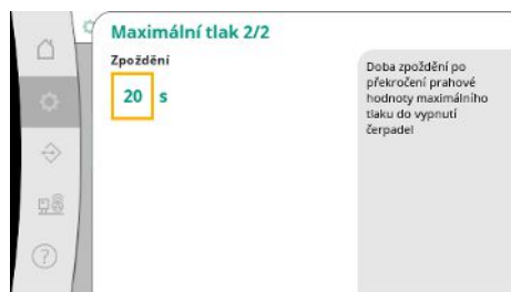
Fig. 33: Bod menu Nastavení → Nastavení kontroly → Maximální tlak 2/2
