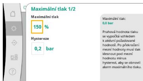
Fig. 32: Bod menu Nastavení → Nastavení kontroly → Maximální tlak 1/2
