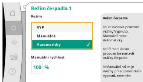
Fig. 20: Bod menu Nastavení -> Pohotovostní režim -> Režim čerpadlo 1
