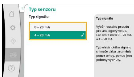
Fig. 98: Bod menu Systém → Sensory → Typ senzoru
