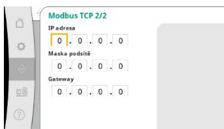
Fig. 76: Bod menu Komunikace → BMS → Modbus TCP 2
