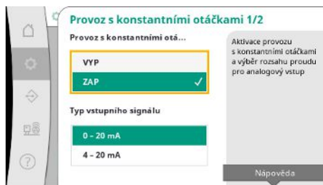
Fig. 46: Bod menu Nastavení → Dodatečné nastavení → Provoz s konstantními otáčkami 1/2
