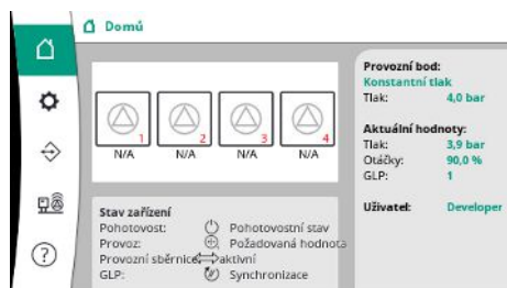
Fig. 17: Hlavní obrazovka v regulačním režimu p–c
