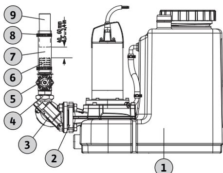
Fig. 3: Raccordement du raccord de refoulement
