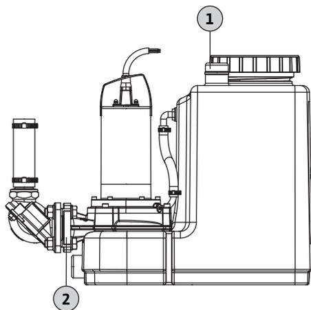
Fig. 6: Raccord de purge du réservoir collecteur
