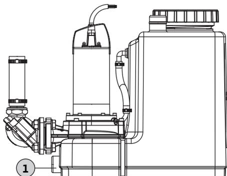
Fig. 7: Raccordement d'une pompe à membrane manuelle
