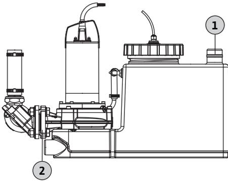
Fig. 8: Raccord de purge du réservoir collecteur
