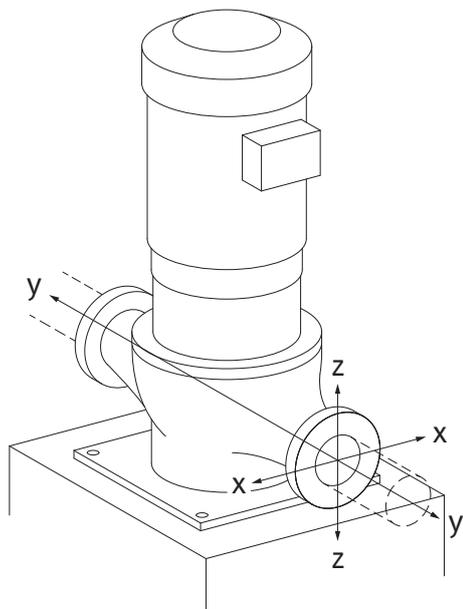
Fig. 7: Slučaj opterećenja 17 A, EN ISO 5199, Dodatak B
