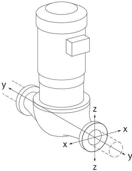
Fig. 6: Slučaj opterećenja 16 A, EN ISO 5199, Dodatak B
