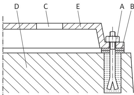
Fig. 12: Primjer vijčanog spoja za temelj
