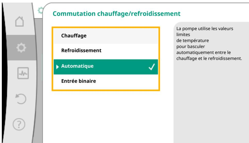
Fig. 38: Commutation Chauffage/refroidissement\_Automatique
